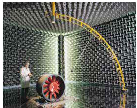
Cámara anecoica / Anechoic chamber
